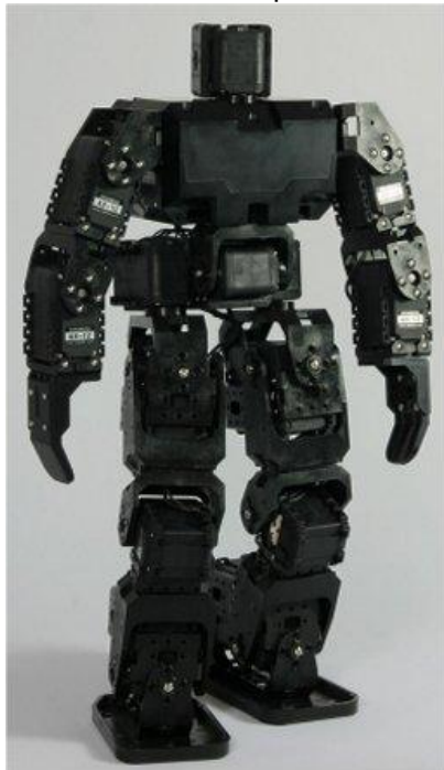
Obr.2 Humanoid -aplikace stavebnice Bioloid
